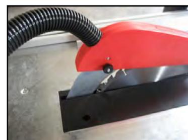
Figura 19 - Montaggio carter copri lama.
