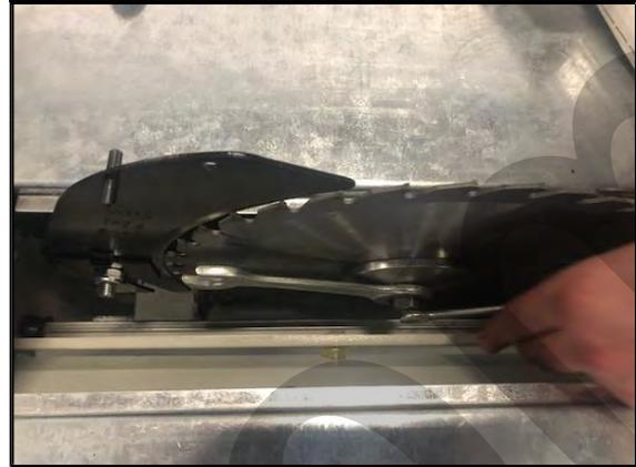
Figura 30 - Rimozione piastra di scorrimento. Figura 31 - Bloccaggio del disco di taglio.
