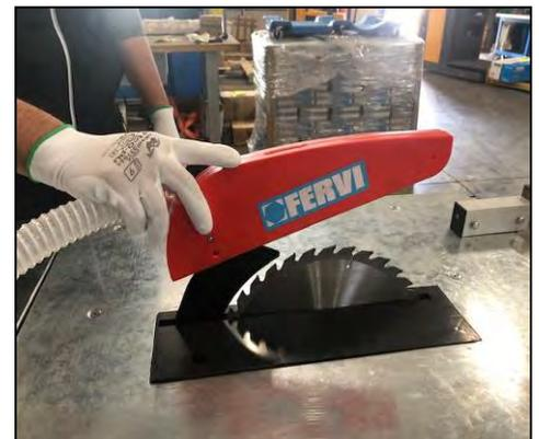
Figura 29 - Rimozione carter copri lama.
