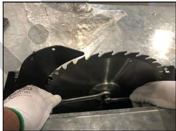
Figura 32 - Smontaggio lama di taglio. Figura 33 - Bloccaggio del disco di taglio.
