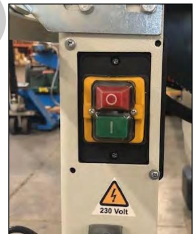
Figura 28 - Avvio/arresto/arresto d'emergenza.
