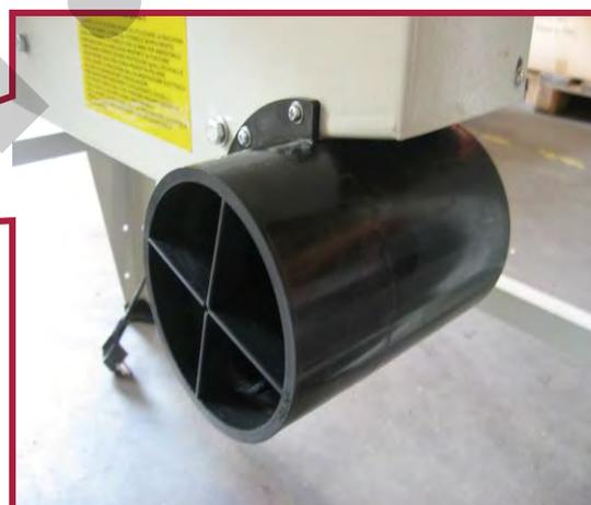
Figura 18 - Montaggio attacco aspiratore.
