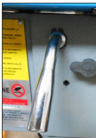
Figura 25 - Leva tensione cinghia.
