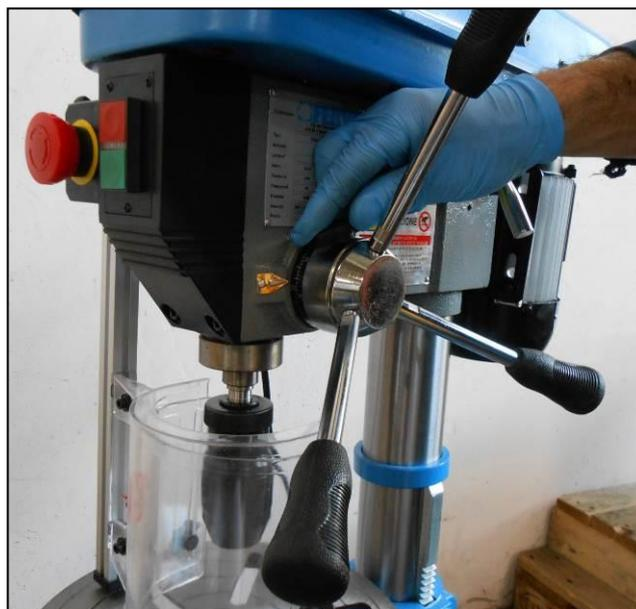
Figura 32 – Regolazione profondità foratura
