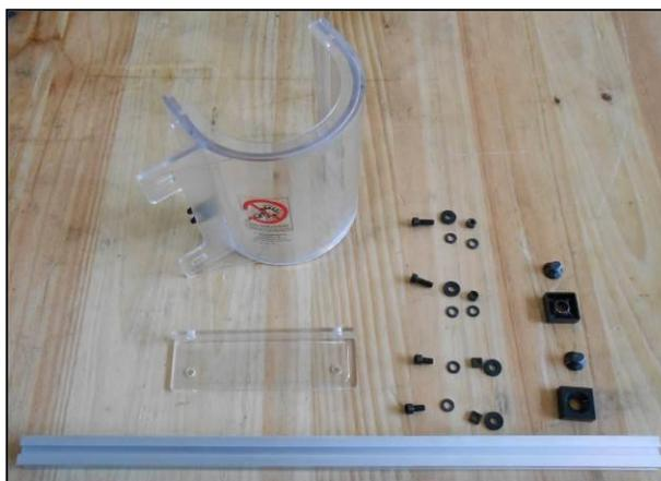
Figura 12 – Parti per il montaggio del riparo
