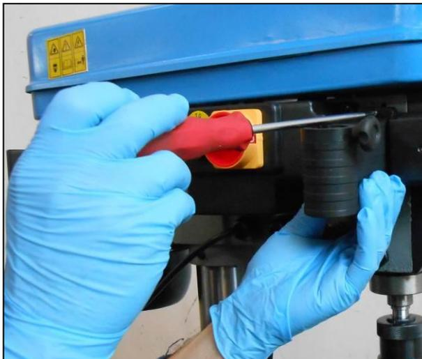
Figura 11 – Montaggio del blocco microinterruttore
