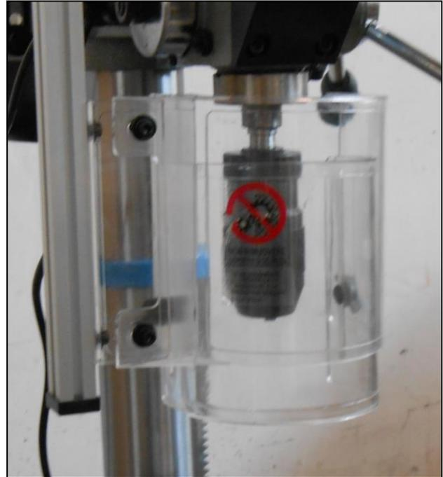
Figura 17 - Inserimento della staffa e posizionamento corretto del riparo
