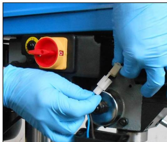
Figura 10 - Collegamento delle connessioni
