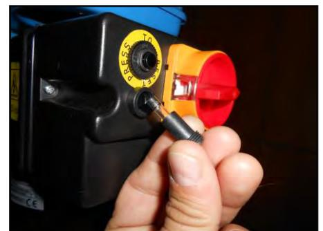
Figura 19 – Fusibile di protezione.
