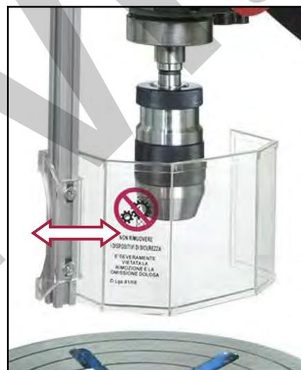
Figura 21 - Scorrimento del riparo in senso longitudinale
