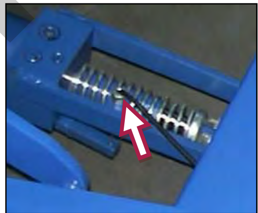
Figura 9 – Bullone di registro cilindro.
