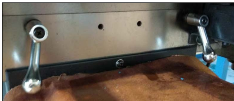
Figura 30 – Leve di bloccaggio della movimentazione longitudinale della tavola.
