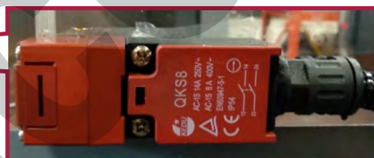
Figura 23 – Carter interbloccato di protezione della tavola portapezzo.
