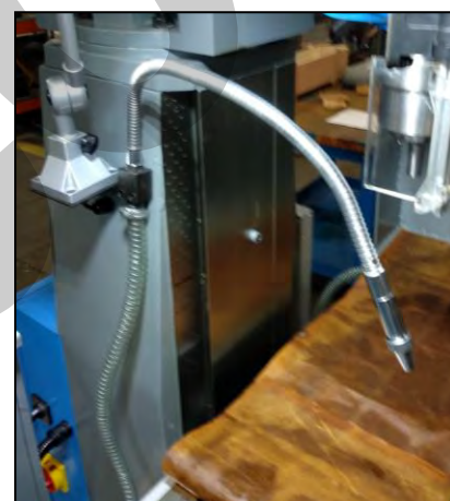
Figura 21 – Rubinetto di uscita del fluido refrigerante.
