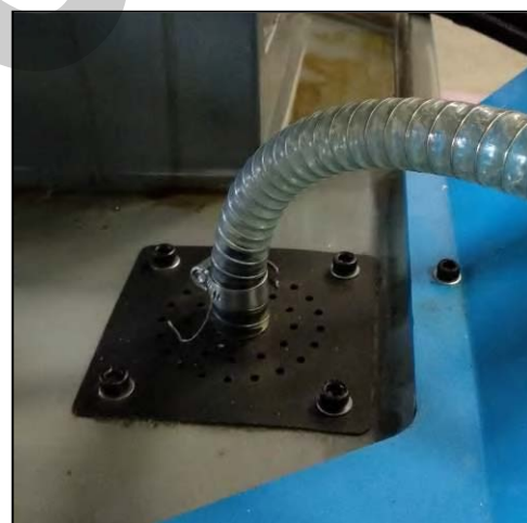
Figura 19 - Foro di ingresso liquido di raffreddamento.
