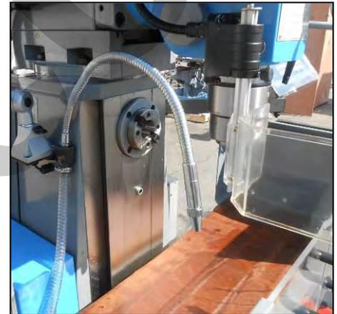
Figura 24 - Rubinetto di uscita del fluido refrigerante.
