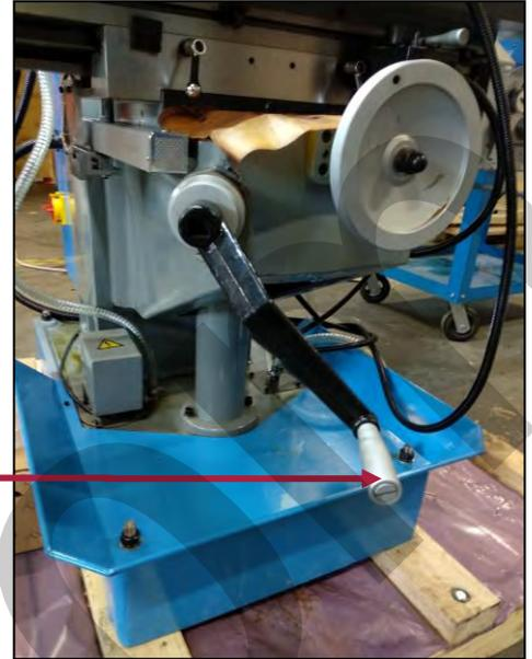
Figura 15 - Leva per la movimentazione verticale della tavola.
