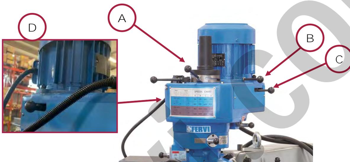
Figura 9 - Regolazione della velocità di rotazione del mandrino.
