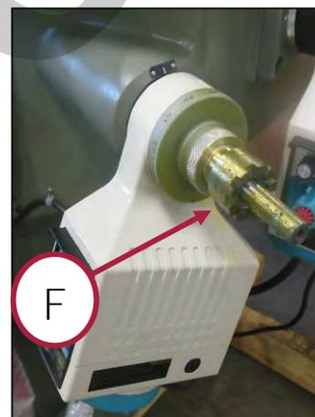
Figura 12 - Leva per la movimentazione verticale della tavola.
