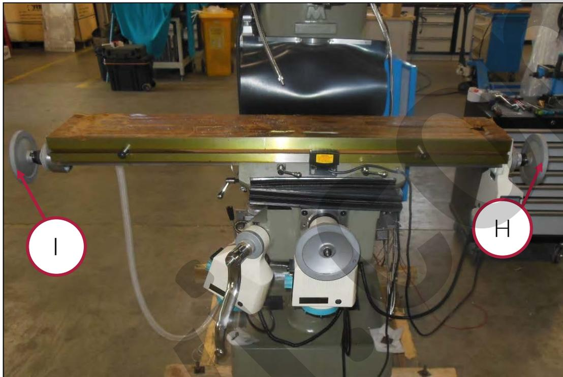
Figura 14 - Volantini per la movimentazione orizzontale della tavola.
