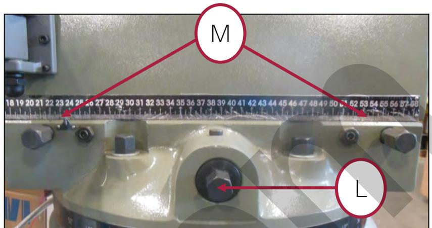
Figura 15 - Leva per la movimentazione radiale della testa.
