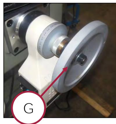
Figura 13 - Volantino per la movimentazione radiale della tavola.
