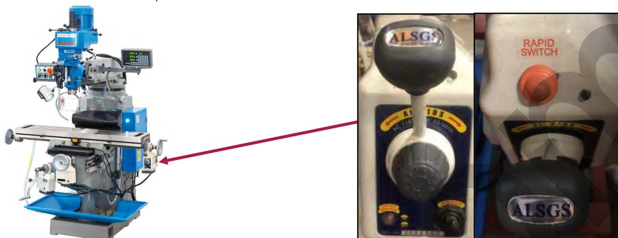
Figura 4 - Targa della velocità di avanzamento automatico della tavola.
