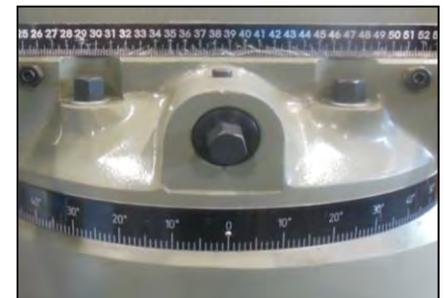
Figura 17 – Viti di fissaggio della testa.
