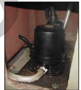
Figura 20 - Foro di ingresso liquido di raffreddamento.
