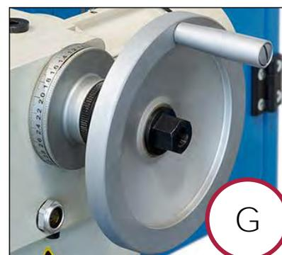
Figura 13 - Volantino per la movimentazione radiale della tavola.
