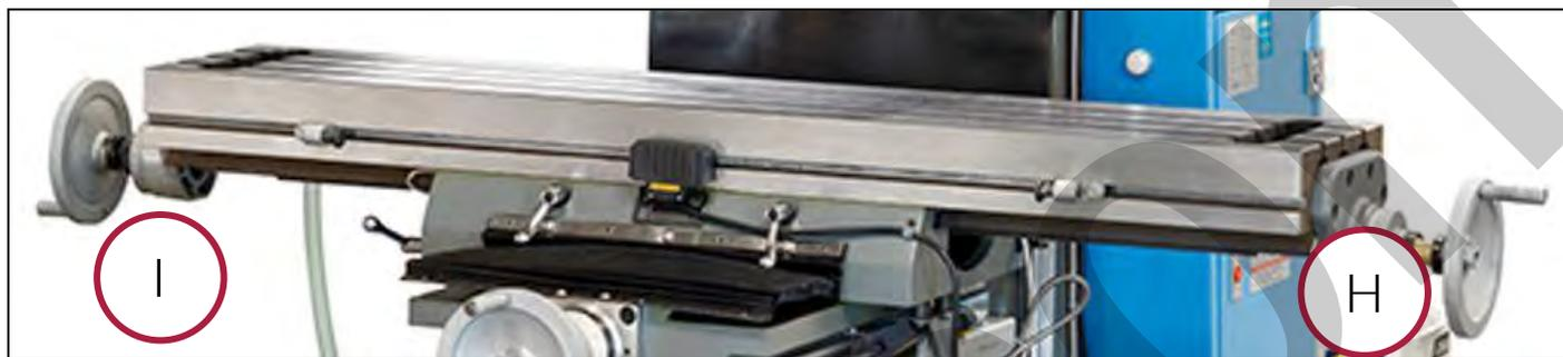
Figura 14 - Volantini per la movimentazione orizzontale della tavola.
