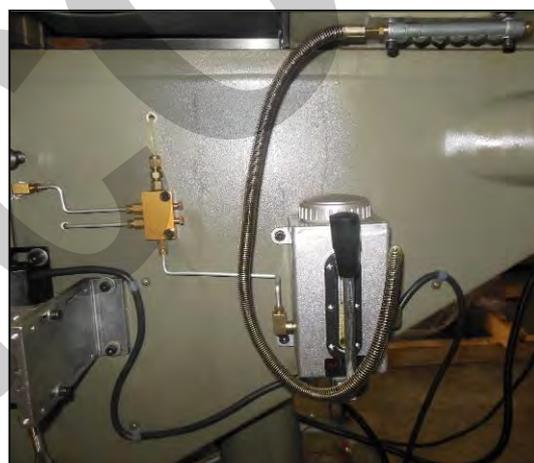
Figura 37 – Impianto di lubrificazione.
