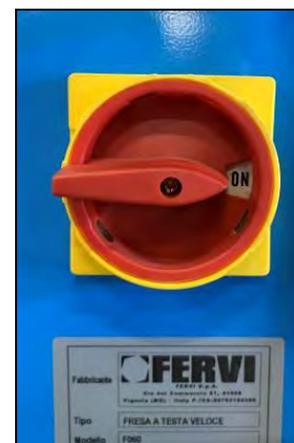
Figura 7 - Sezionatore generale dell'alimentazione elettrica.
