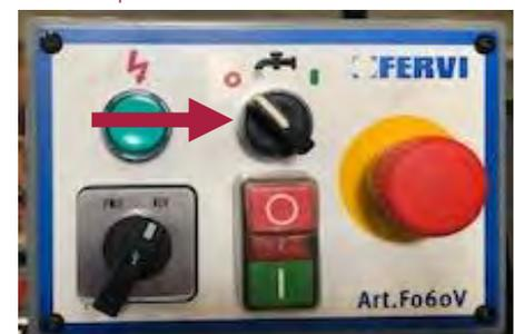
Figura 21 - Selettore per l'attivazione della pompa di aspirazione del liquido refrigerante.
