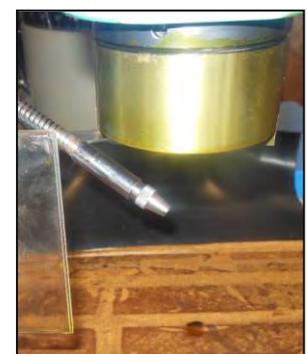
Figura 22 - Rubinetto di uscita del fluido refrigerante.
