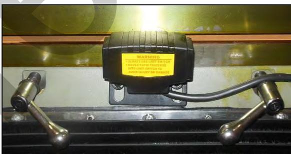
Figura 28 – Leve di bloccaggio della movimentazione trasversale della tavola.
