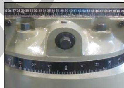
Figura 17 – Viti di fissaggio della testa.
