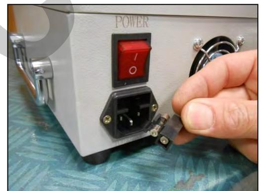
Figura 5 – Fusibile di protezione del circuito elettrico.
