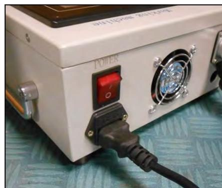
Figura 12 – Collegamento alimentazione.
