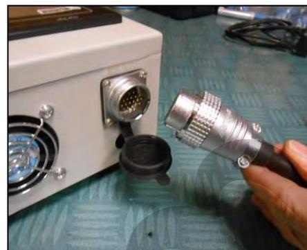
Figura 10 – Connettore e cavo di controllo.
