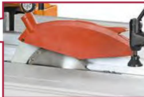
Figura 11 - Carter di protezione della lama.
