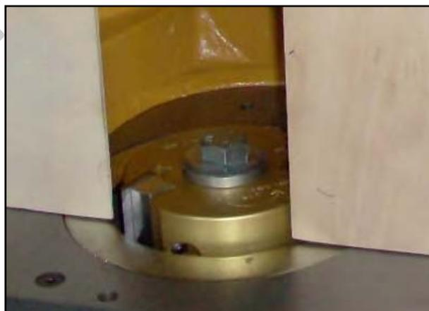
Figura 21 – Fissaggio utensile.
