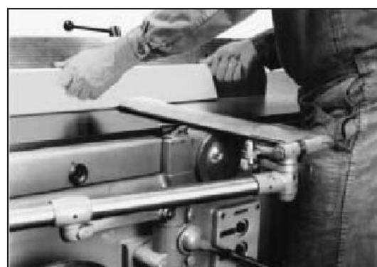
Figura 31 – Piallatura con guida inclinata a 45°.
