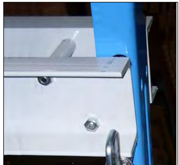
Figura 12 – Fissaggio del bancale.
