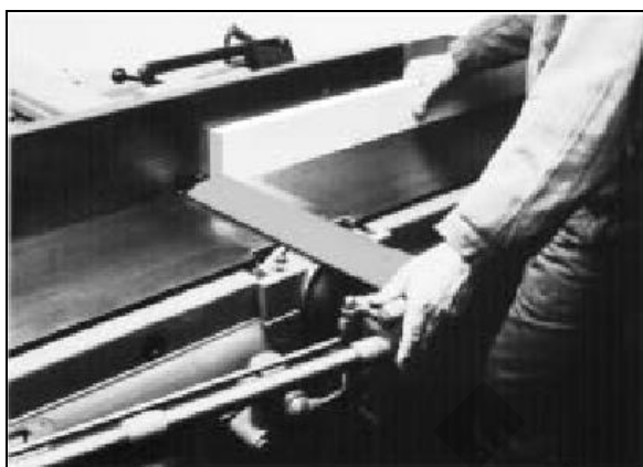
Figura 14 – Regolazione del riparo. Figura 15 – Piallatura sul bordo.
