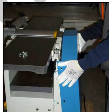
Figura 6 – Montaggio del carter di protezione.
