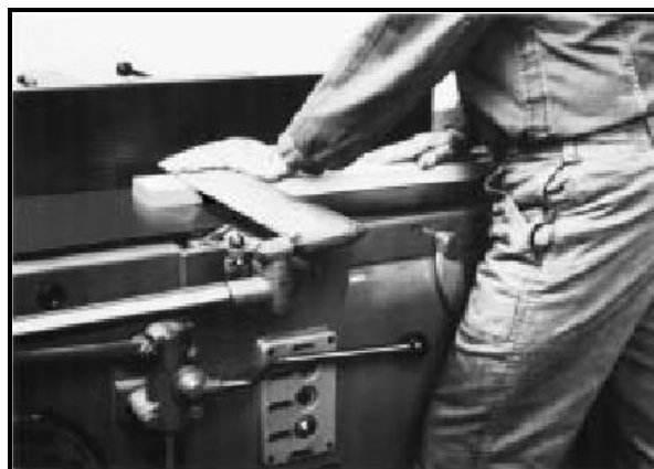
Figura 12 – Regolazione del riparo. Figura 13 – Piallatura di faccia.
