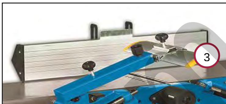
Figura 7 – Ripari dell'albero della pialla.
