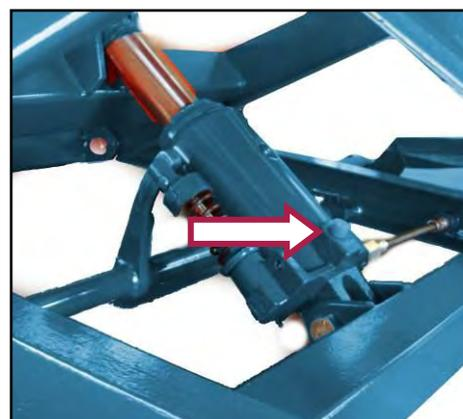
Figura 6 – Dettaglio valvola.
