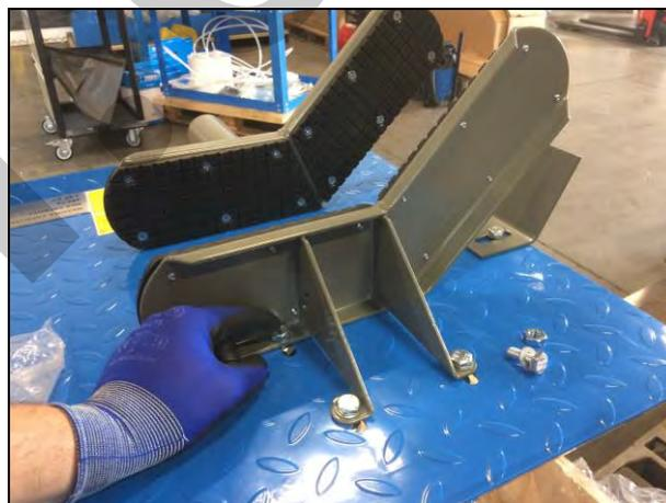
Figura 12 – Montaggio della morsa di bloccaggio ruota.
