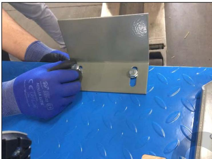
Figura 11 – Montaggio della piastra ferma ruota.
