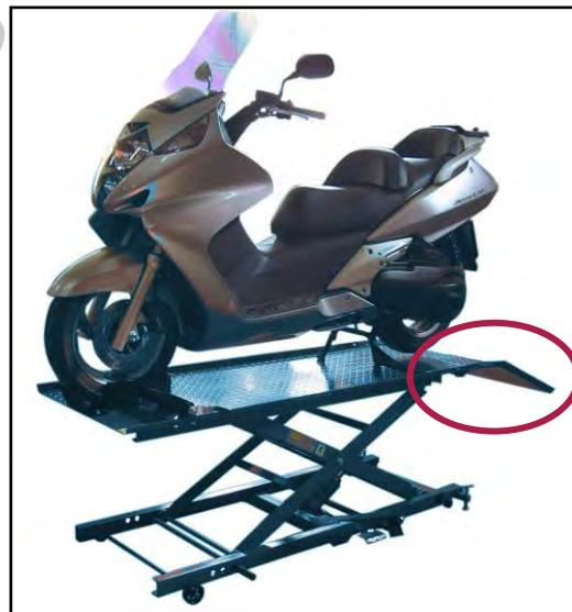
Figura 23 – Smontare la rampa.
