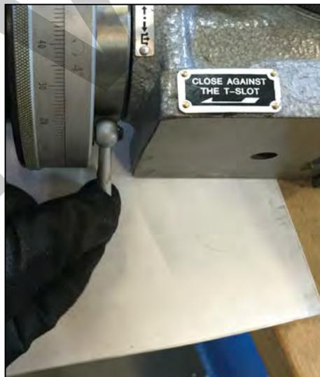
Figura 6 – Leva sblocco volantino
