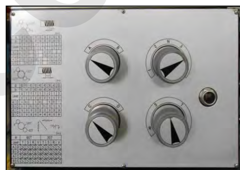
Figura 5 – Regolazione velocità avanzamenti automatici.
