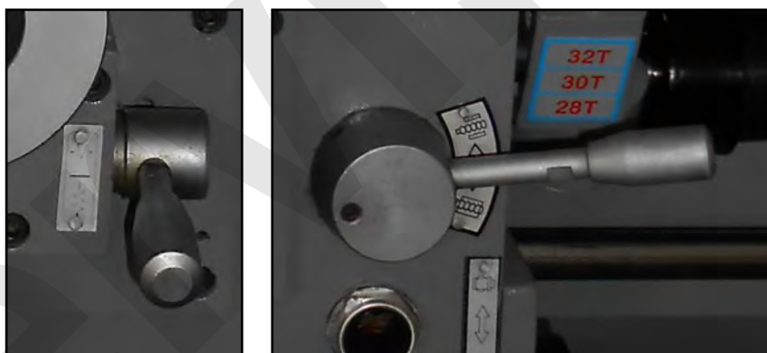
Figura 23 – Dettaglio leva selezione avanzamenti automatici e leva della chiocciola spaccata.
