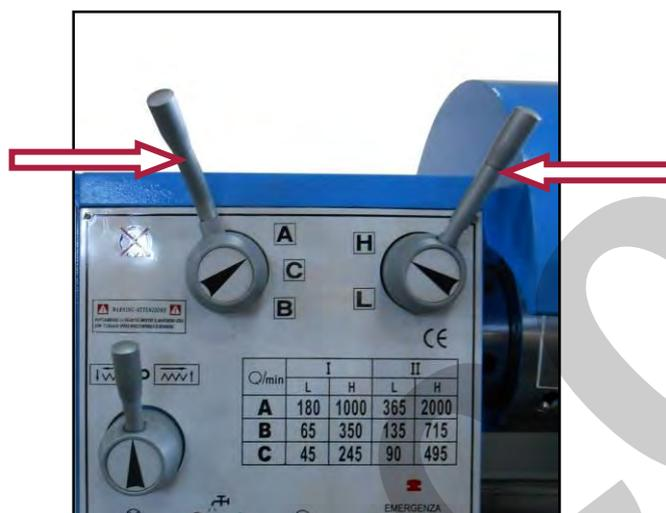
Figura 20 – Manopole di regolazione della velocità.
