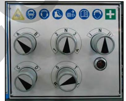
Figura 6 – Regolazione velocità.
