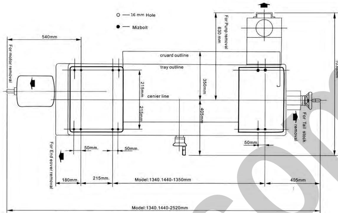
Figura 16 – Dimensioni e punti di fissaggio.
