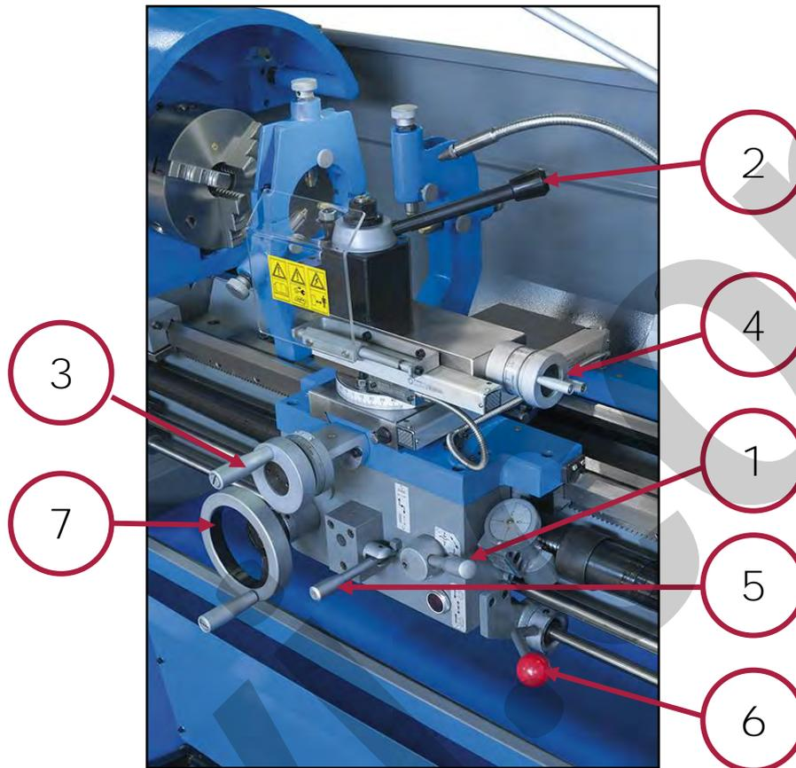
Figura 26 – Leve e volantini del carrello.
