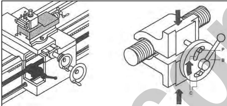
Figura 41 – Avanzamento longitudinale con la vite madre.
