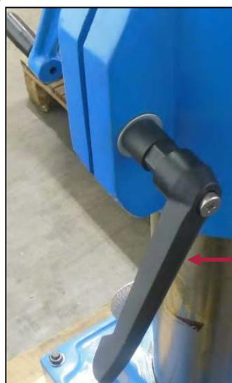
Figura 11 – Manovella regolazione tavola e leve di bloccaggio.
