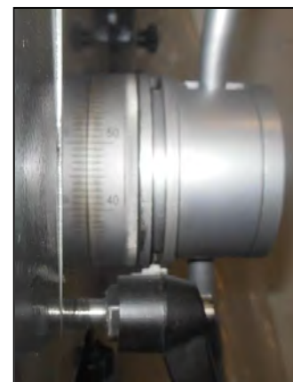
Figura 10 – Ghiera di regolazione avanzamento mandrino.
