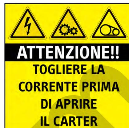
Figura 18 – Pittogramma sul carter di trasmissione.
