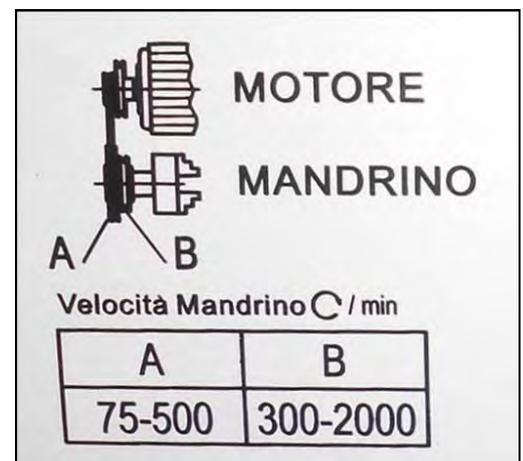
Figura 5 - Targa per la regolazione della velocità.
