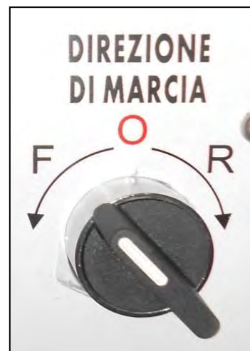
Figura 7 – Selettore verso di rotazione del mandrino.
