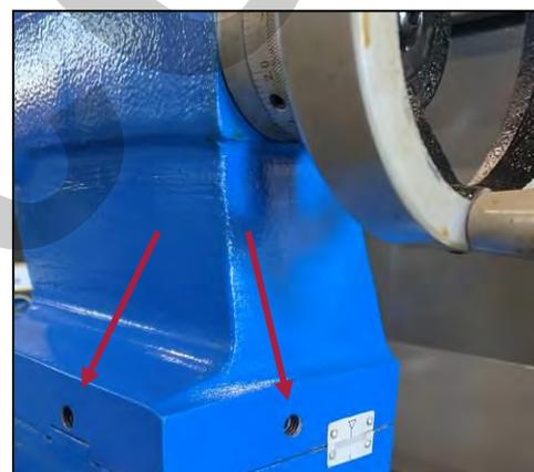
Figura 35 – Vite di regolazione.
