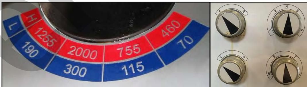
Figura 19 – Manopole di regolazione della velocità.
