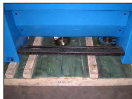
Figura 26 - Dettaglio pedale.
