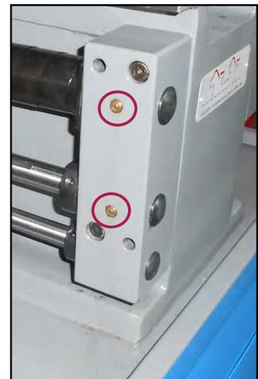
Figura 43 – Punti di lubrificazione della macchina.
