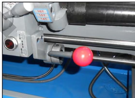
Figura 12 – Leva di avviamento e inversione.
