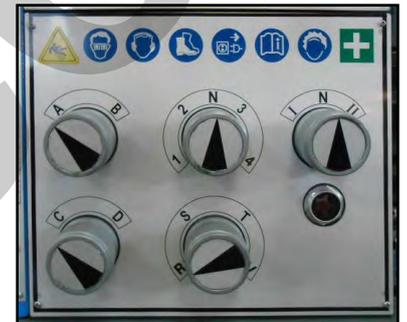
Figura 6 – Regolazione velocità.
