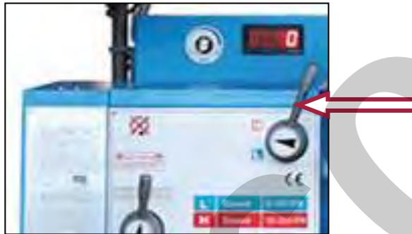
Figura 20 – Leva di selezione della velocità.
