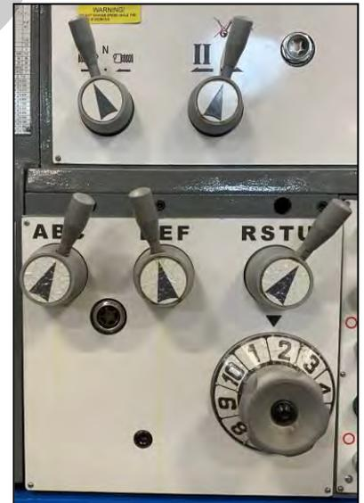
Figura 5 – Regolazione velocità.
