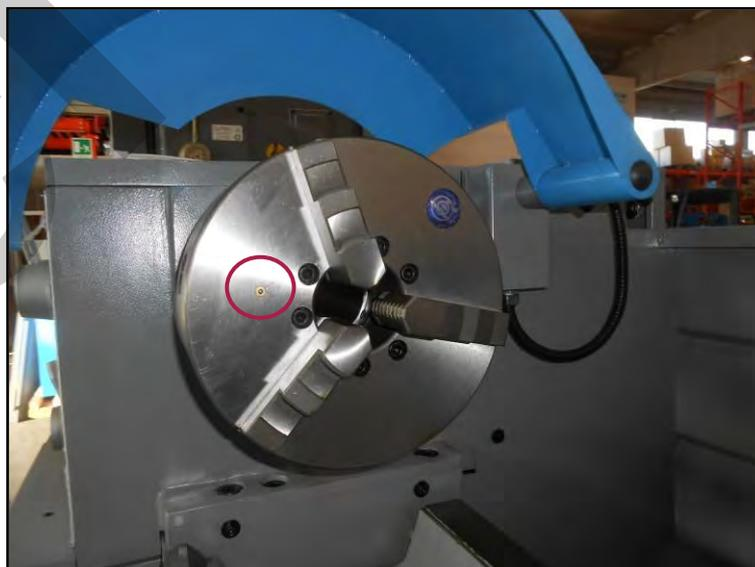
Figura 43 – Punti di lubrificazione della macchina.
