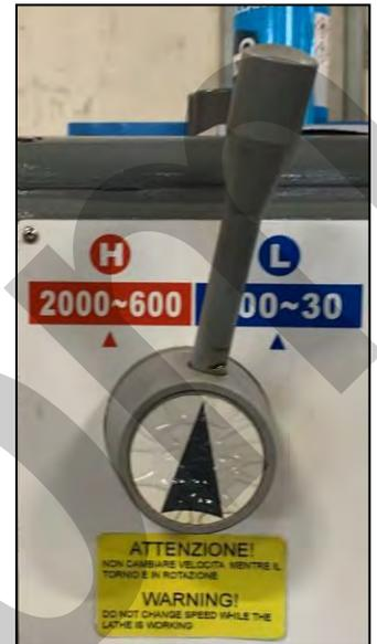
Figura 4 – Leve regolazione range velocità.
