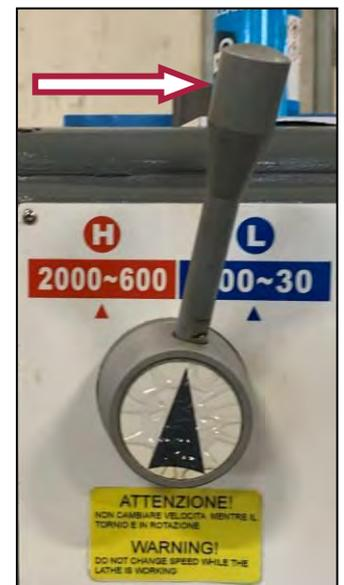
Figura 18 – Manopole di regolazione della velocità.
