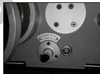
Figura 27 - Leva di pompaggio lubrificante.
