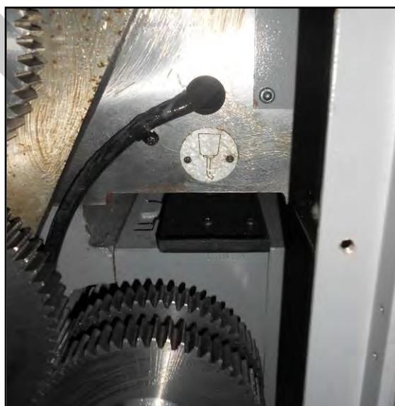
Figura 44 – Punti di lubrificazione della macchina.
