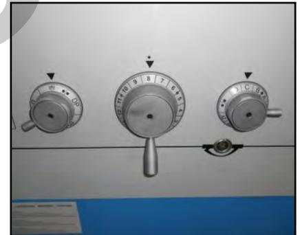
Figura 5 – Regolazione velocità.
