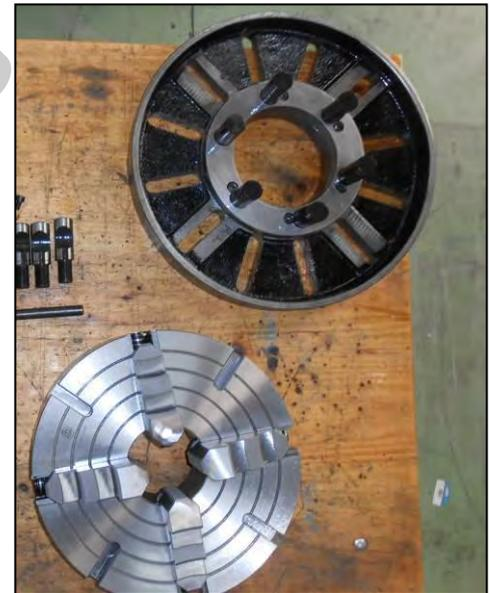
Figura 49 – Accessori forniti con il tornio T095F.
