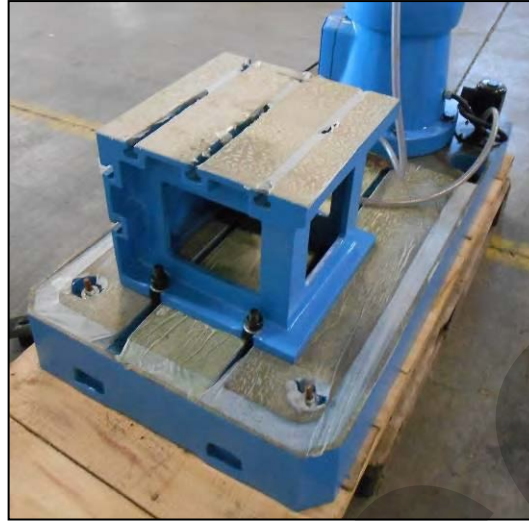
Figura 24 – Fissaggio al pavimento.
