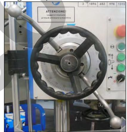
Figura 26 - Volantino di avanzamento e nonio posteriore.
