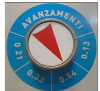
Figura 10 - Leva di regolazione della velocità di avanzamento verticale del mandrino.
