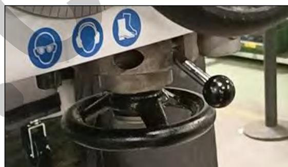
Figura 12 – Leva di avanzamento automatico.
