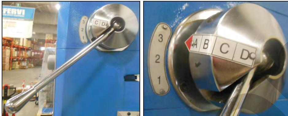
Figura 9 - Leva di regolazione della velocità di rotazione del mandrino.
