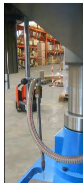
Figura 19 - Zona terminale del circuito di raffreddamento con rubinetto.
