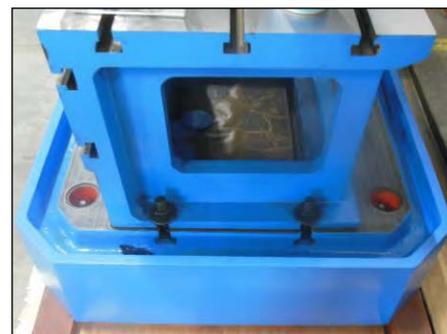
Figura 24 – Fissaggio al pavimento.
