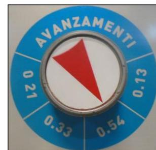
Figura 4 - Targa delle velocità di avanzamento automatico verticale della testa.
