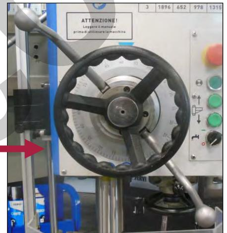
Figura 15 - Volantino di avanzamento orizzontale.
