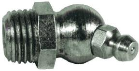
M 8X1 - inclinato a 45°. A testa sferica. A norma UNI 7663 A. In acciaio AVP 11 SmPb37 - UNI EN 10204. Trattamento: zincatura bianca (7 micron). Adatto per ogni tipo di grasso tipo di grasso
