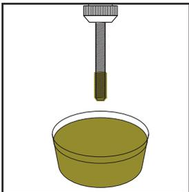
Al fine di ridurre l'usura del tirante ed evitarne il blocco, è fortemente raccomandato di aggiungere regolarmente (+/- ogni 5 inserti filettati posati) un po' di grasso all'estremità del tirante (contenitore in dotazione).
